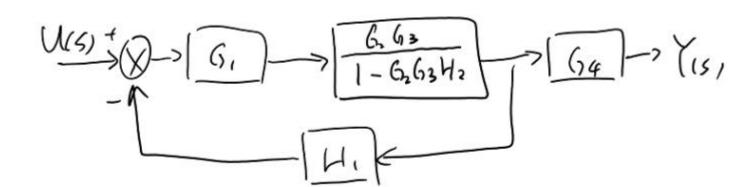
$$A = \frac{\frac{G_1 G_2 G_3}{1 - G_2 G_3 H_2}}{1 + \left(\frac{G_1 G_2 G_3}{1 - G_2 G_2 H_2}\right) (H_1)} = \frac{G_1 G_2 G_3}{1 - G_2 G_3 H_2 + G_1 G_2 G_3 H_1}$$
