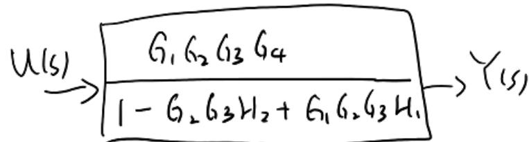
$$\frac{Y(s)}{U(s)} = \frac{G_1 G_2 G_3 G_4}{1 - G_2 G_3 H_2 + G_1 G_2 G_3 H_1}$$
