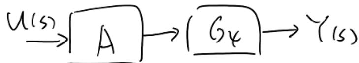
$$A = \frac{\frac{G_1 G_2 G_3}{1 - G_2 G_3 H_2}}{1 + \left( \frac{G_1 G_2 G_3}{1 - G_2 G_3 H_2} \right) (H_1)} = \frac{G_1 G_2 G_3}{1 - G_2 G_3 H_2 + G_1 G_2 G_3 H_1}$$
